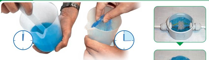
Verter los componentes en el medidor, mezclar y dejar reticular (unos 15 minutos). Retirar el producto aislante, y aplicarlo en pequeñas partes alrededor de la conexión de modo que esta quede completamente recubierta. Naturalmente el producto aislante puede ser conservado con mezclas precedentes.
