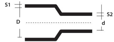
D = Ø diamètre minimal avant le rétrécissement
