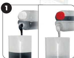
1 De 2 componenten uitstorten in de verhouding 1:1.
